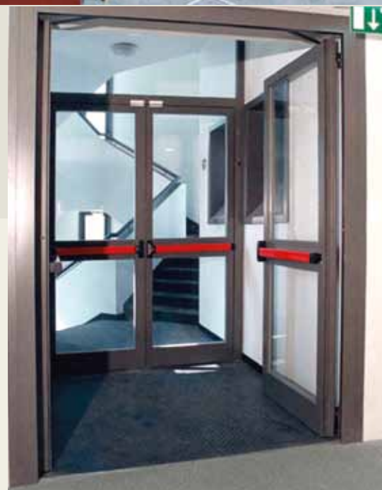
Vetrata tagliafuoco in alluminio a due ante complessa, verniciata Ral 8017, composta da un sopraluce fisso, con doppio maniglione antipanico a barra rossa.
