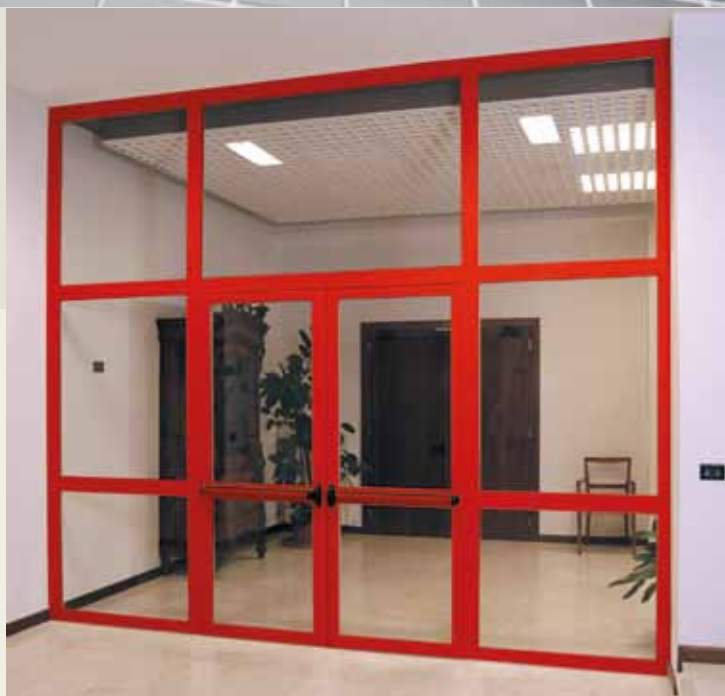
Vetrata tagliafuoco in acciaio a due ante complessa, verniciata Ral 3000, composta da due fianchi luce fissi e da un sopraluce fisso, con doppio maniglione antipanico a barra rossa.
